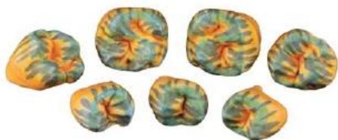
Konečné barvení, před sintračním procesem
